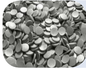
Alubutzen sind das Ausgangsprodukt für Aluminiumdosen , die aus einem Stück gefertigt werden.
